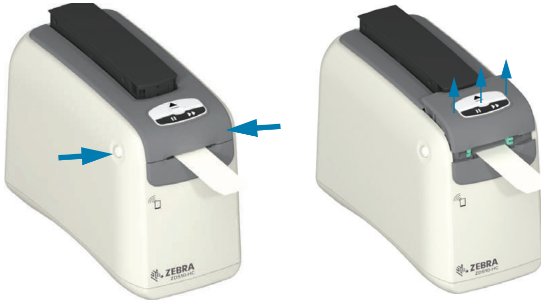
Figura 8 • Liberación del papel debajo de la cubierta superior
